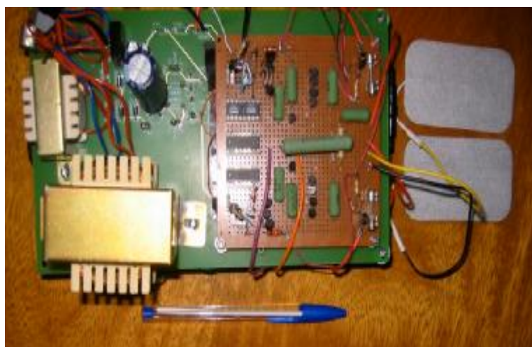
FIGURA 7. 3 - IMAGEM DA PLACA COM O AMPLIFICADOR DE POTÊNCIA.
