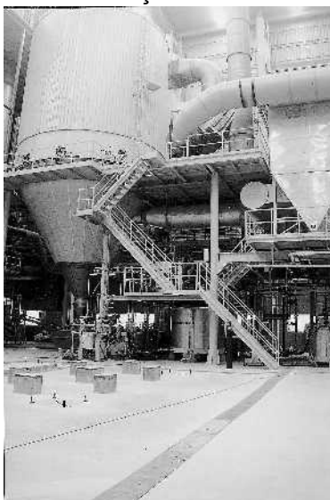
Figura 21 - Processo Produtivo Cerâmico - Atomização
