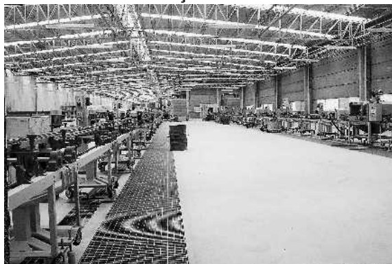
Figura 24 - Processo Produtivo Cerâmico - Esmaltação
