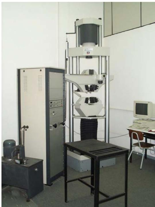
**Figura 121 – Máquina Universal de Ensaios.**
