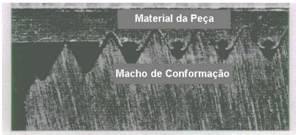
**Figura 23** - Formação dos filetes no rosqueamento por conformação [1,2,44,46].
