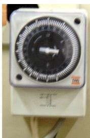
**Figura 31** - Temporizador utilizado para o controle das duas bombas dosadoras.
