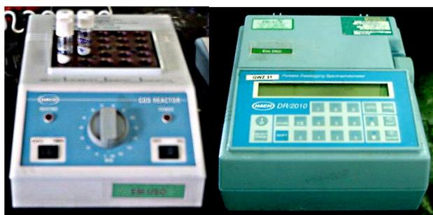
Figura 24 - Digestor e espectrofotômetro DR 2010 – HACH
