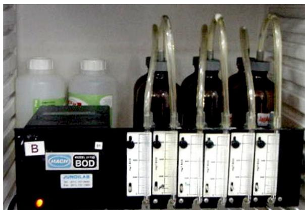
Figura 25 – Aparelho de DBO Manométrico - HACH
