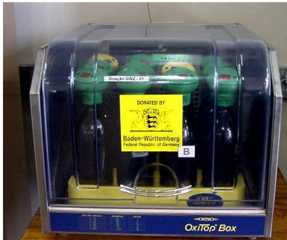
Figura 26 – Aparelho de DBO – OXITOP
