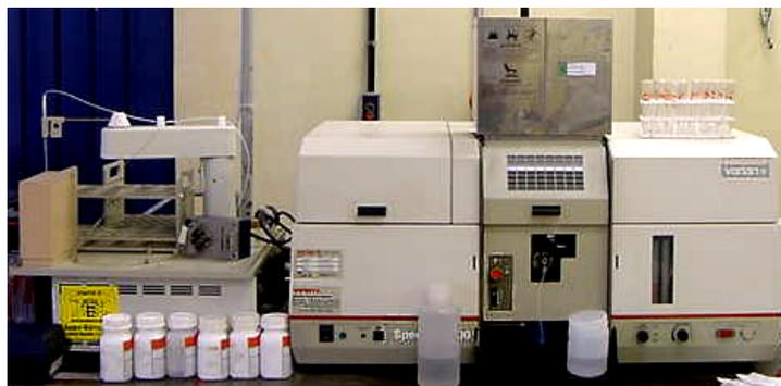
Figura 29 – Espectrofotômetro de absorção atômica – VARIAN modelo AA 200
