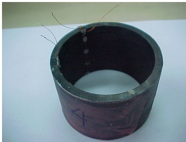
Figura A.2- Amostra para o teste com medição do torque
