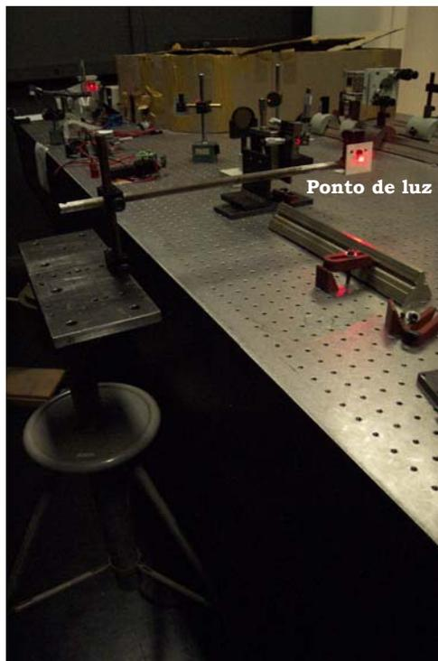
Figura 5.21 Ponto de luz refletido por uma superfície sem isolamento contra vibrações
