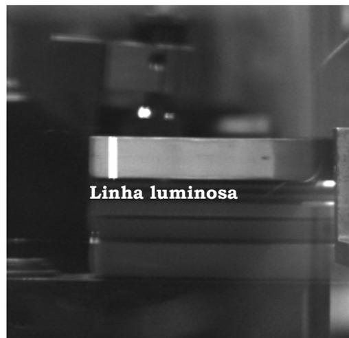
Figura 5.18 Linha luminosa gerada com um plano de luz
