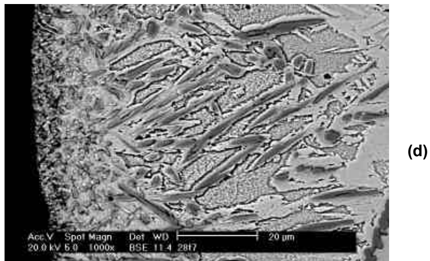
Figura 39 -Micrografias da liga com 28% Cr para 15 min (a) e 120 min (b) de absorção de nitrogênio na DLA a 950°C e ampliação de a (c) e b (d).
