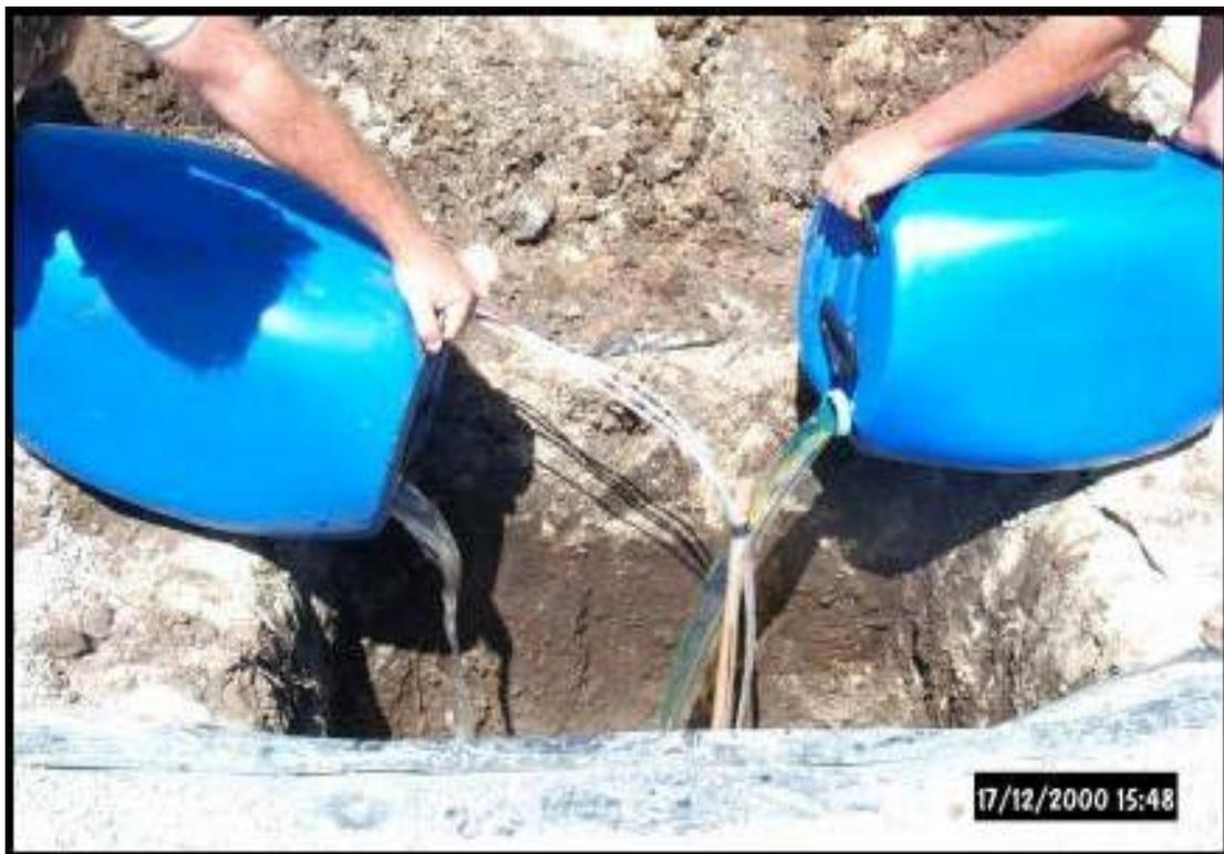
Figura 3.3 - Derramamento para o experimento de Diesel mais etanol.
