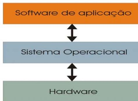
**Figura 12 - Estrutura funcional de um sistema operacional**
