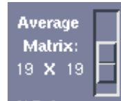
Figura 28 - Controle de ajuste do tamanho da área (matriz de pontos) a ser analisada
