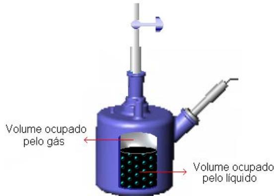
Figura 3.1. Esquema de um bioreator anaeróbico
