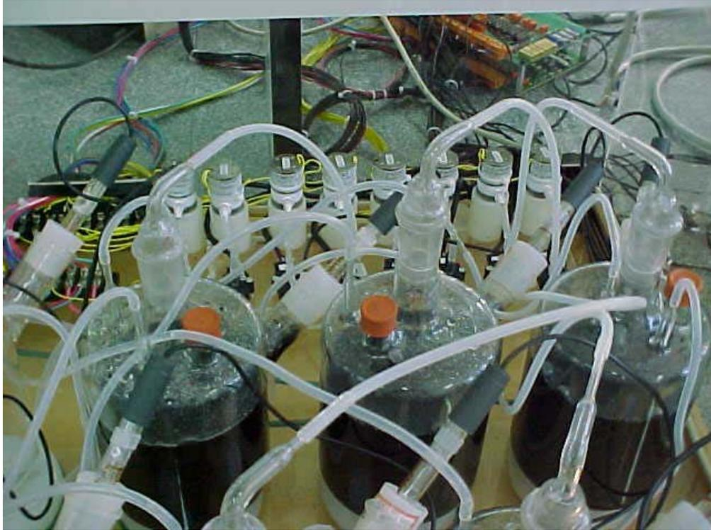
Figura 4.2. Respirômetro Anaeróbio. Fotografia 2
