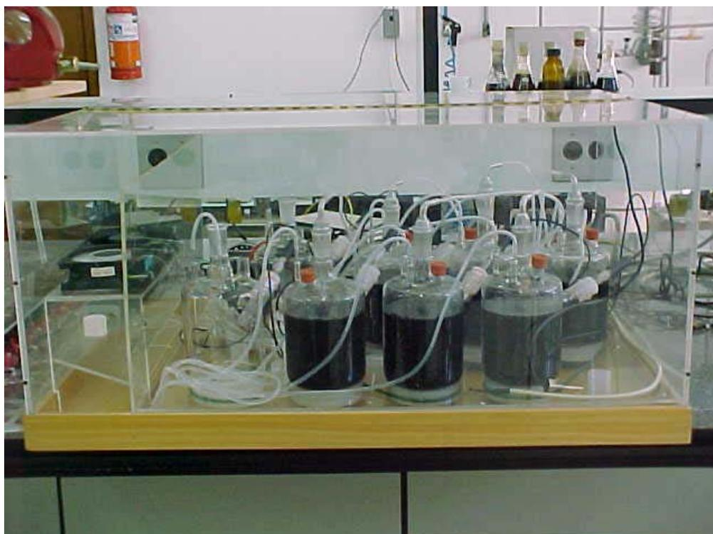
Figura 4.1. Respirômetro Anaeróbio. Fotografia 1.
