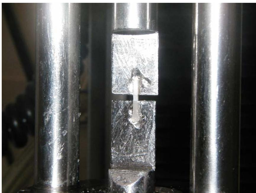
**Figura 20:** Amostra sendo tracionada. Observe em detalhe a montagem da amostra no Bencor multi-t, onde esta é fixada.
