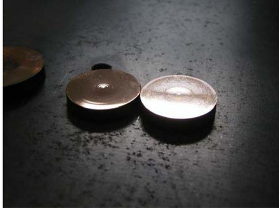
**Figura 12** – Espelhos cônicos de cobre utilizados neste trabalho
