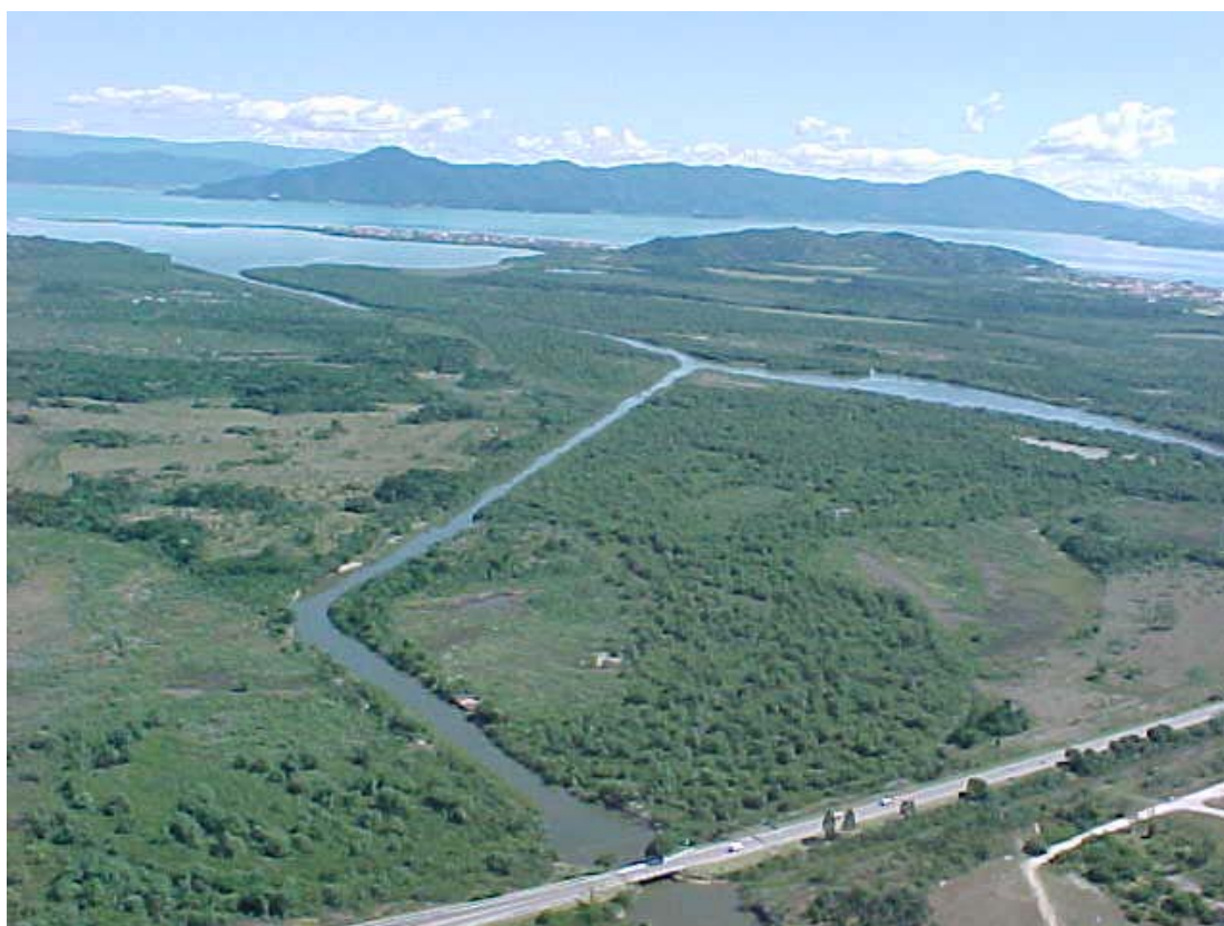
Foto 3: Vista aérea para noroeste, onde pode ser observada o canal retificado pelo extinto DNOS para o escoamento das águas acima da maré. Enseada de Ratores, Ilha de Santa Catarina, SC, Brasil (Fotógrafo Paulo Benincá, 2001).
