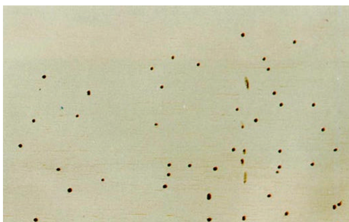
FOTO 11 – Perfurações pequenas causadas pelo ataque de insetos ou larvas
