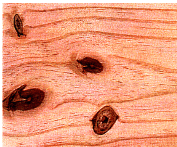
FOTO 10 – Grupo de Nós – Dois ou mais nós separados entre si por fibras desviadas do sentido da grã.
