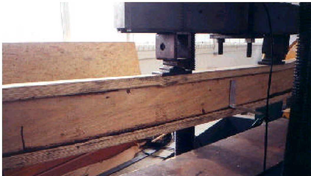
FOTO 51 – Ruptura da Viga Mesa LVL – V3 – Compressão da Mesa Superior
