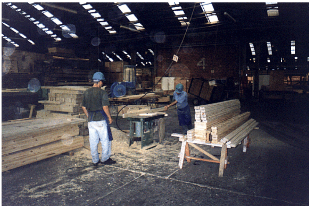
FOTO 32 – Confecção do Finger-Joint na Mesa da Viga
