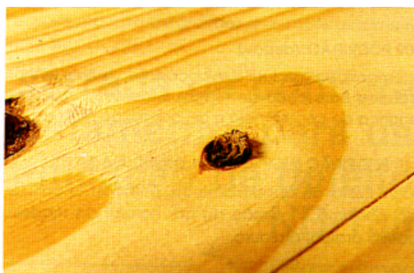
FOTO 5 – Nó solto – Apresenta-se total ou parcialmente envolvido por casca, normalmente não se mantém retido na peça de madeira.
