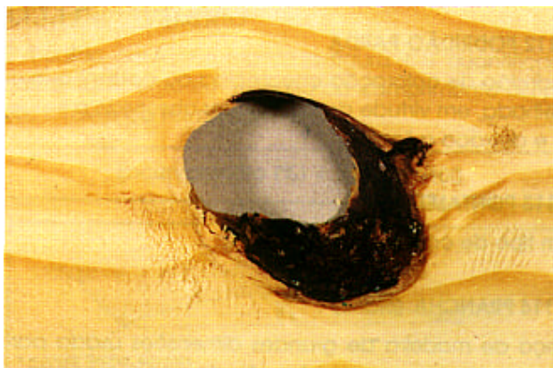
FOTO 7 – Nó vazado – Orifício na peça provocado pelo desprendimento do material deteriorado.
