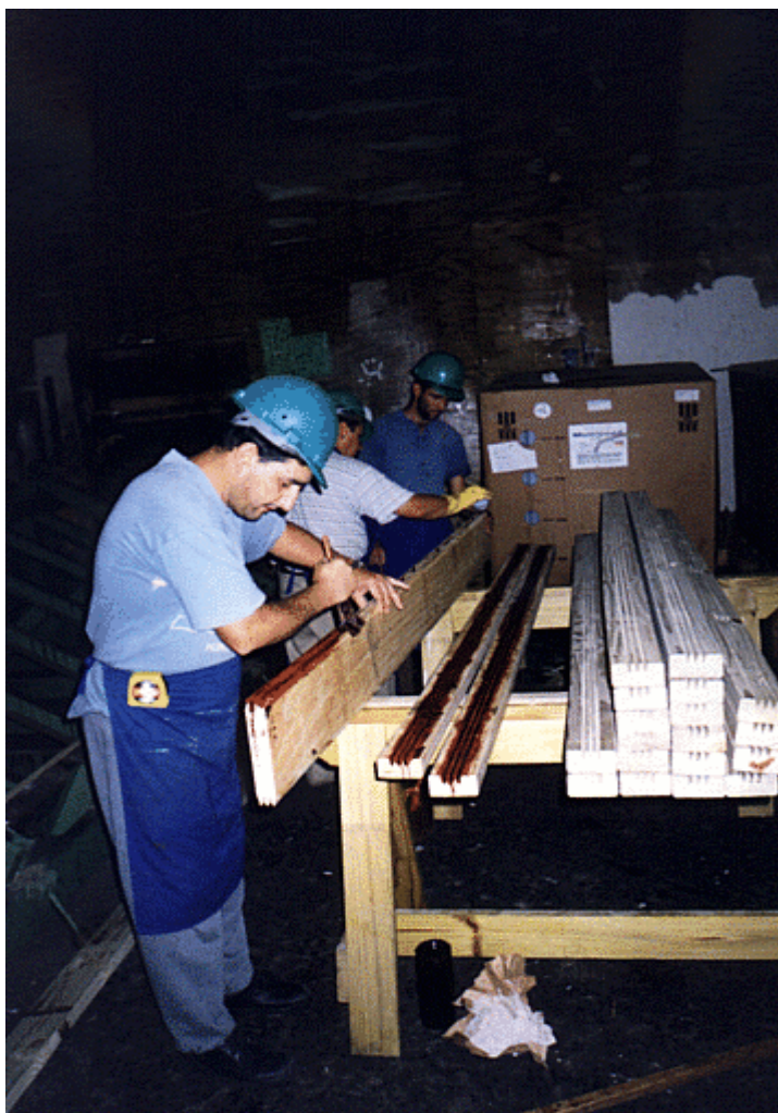
FOTO 34 – Aplicação manual de cola na mesa e na alma
