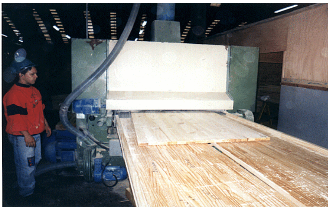
FOTO 22 – Colagem do sarrafeado de Madeira
