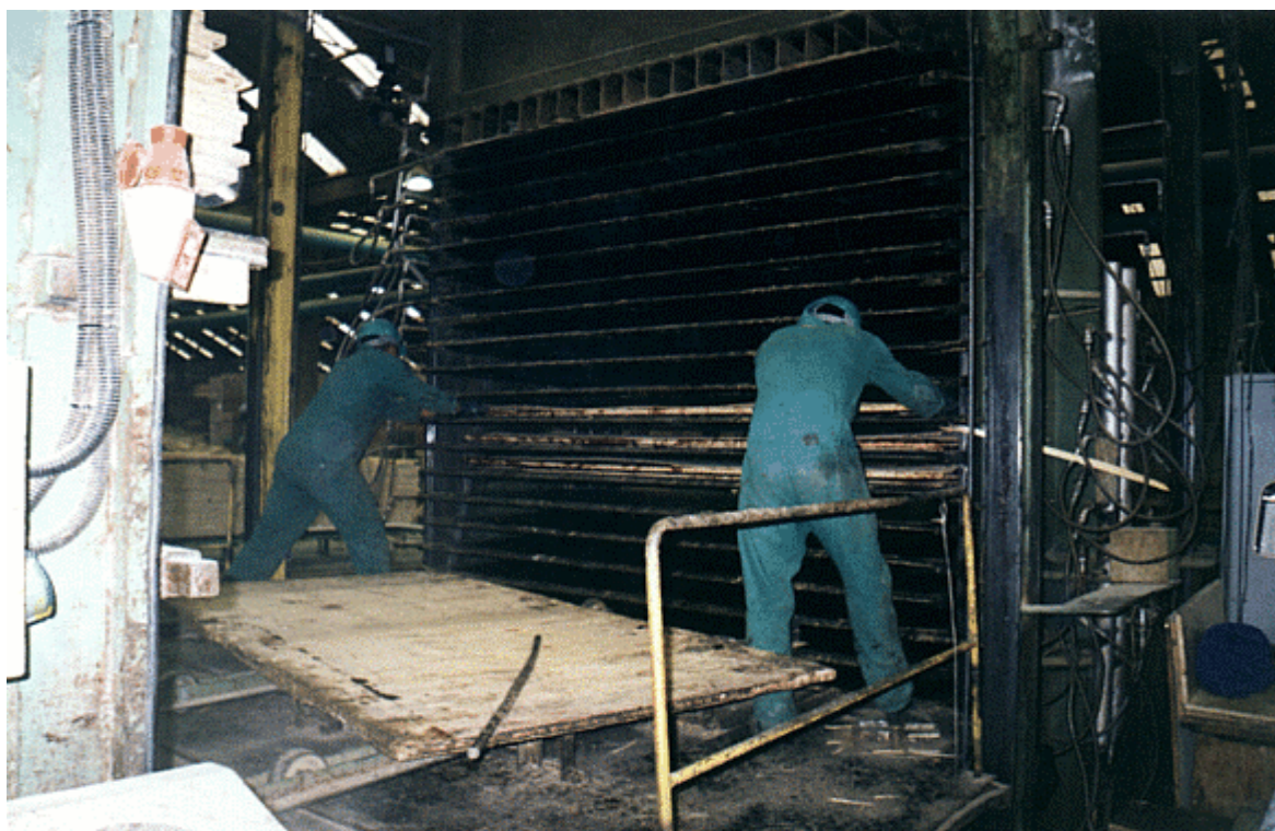
FOTO 24 – Prensagem do Composto Blockboard
