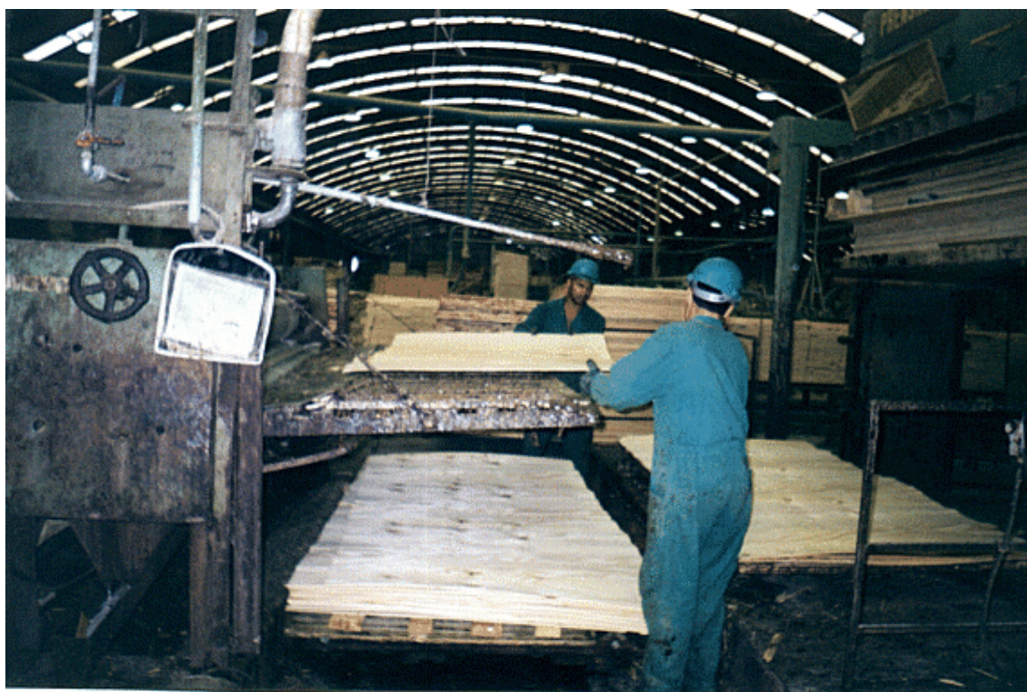
FOTO 25 – Retirada do Composto “Blockboard” da prensa
