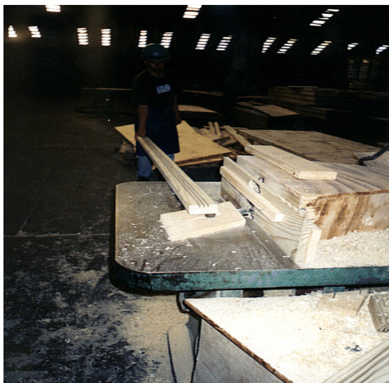
FOTO 33 – Finger-Joint na Mesa da Viga
