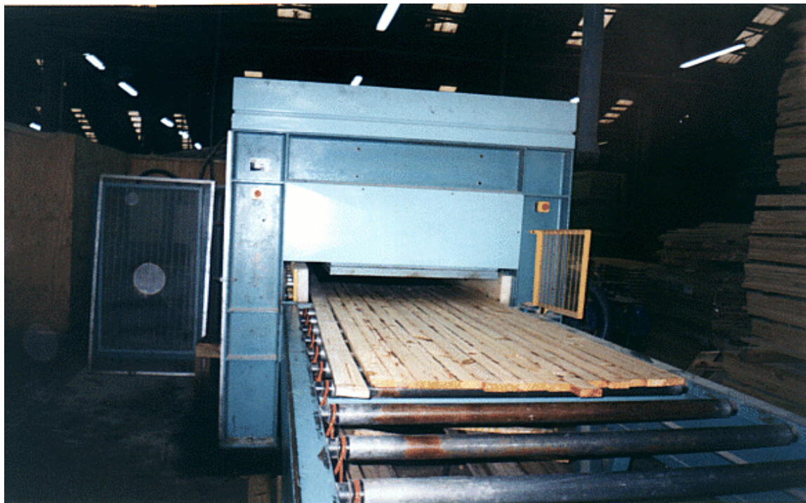
FOTO 22 – Colagem do sarrafeado de Madeira
