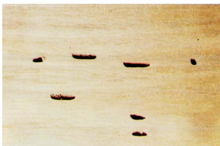
FOTO 12 – Perfurações grandes causadas pelo ataque de insetos ou larvas
