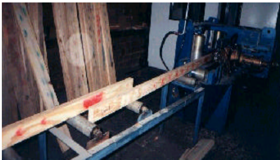
FOTO 41 – Classificação Mecânica – Mesa LVL – Cor Vermelho
