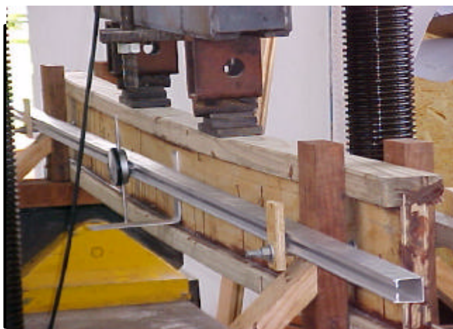
FOTO 44 – Sistema de Carregamento e leitura da Flecha
