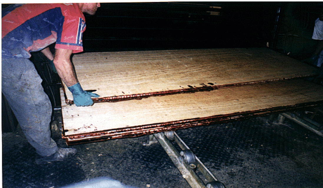
FOTO 26 – Retirada do Composto “Blockboard” da prensa
