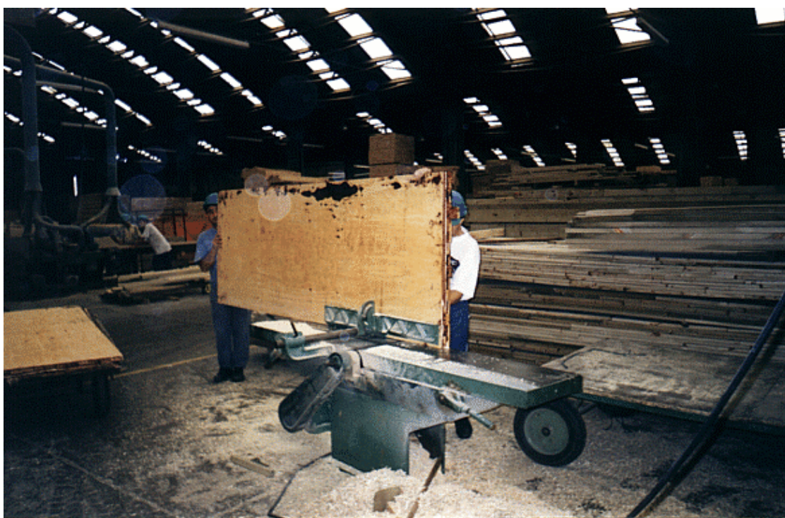
FOTO 27 – Refilamento do Composto “Blockboard”
