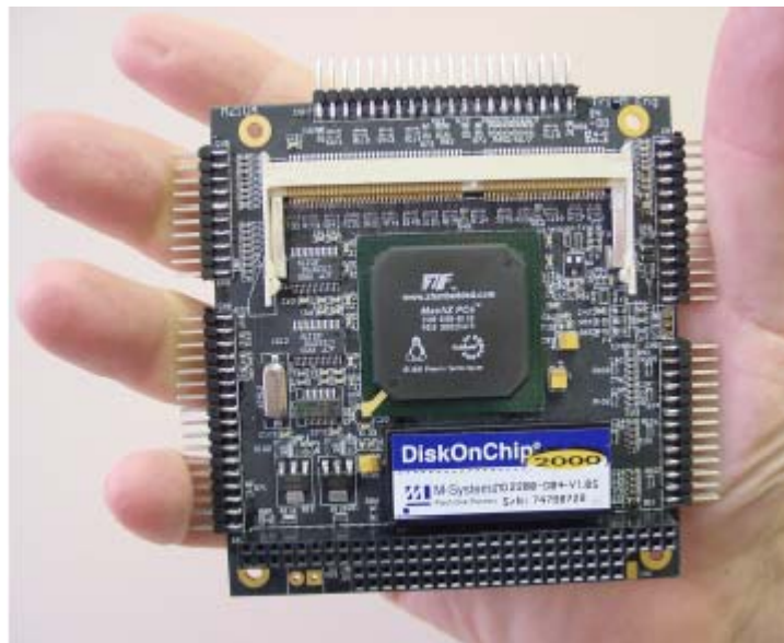
Figura 7.2 Placa mãe PC104 do subsistema PacienteIP, com processador MachZ.
