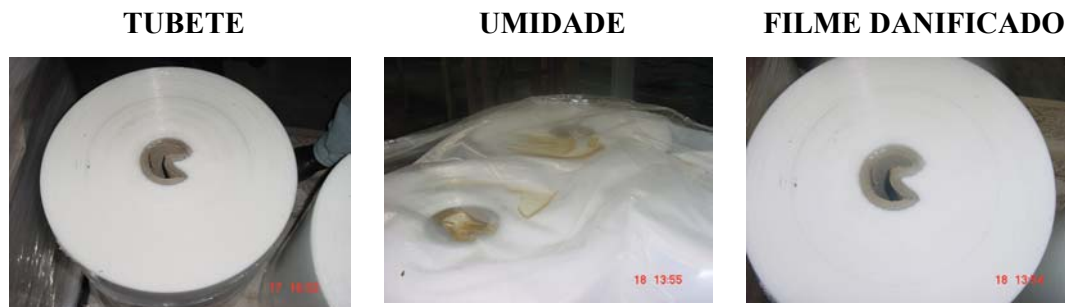
FIGURA 31 - CONDIÇÕES INADEQUADAS DAS BOBINAS
