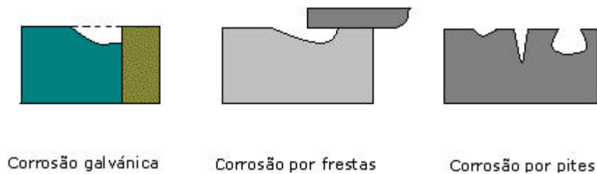
FIGURA 2.2: Sumário esquemático das formas de corrosão nos materiais obtidos a partir da metalurgia do pó.
