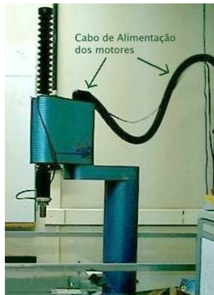
Figura 5.23: Imagem ressaltando fixação dos cabos de alimentação dos motores do robô Inter/Scara.
