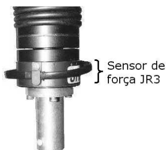
Figura 4.2: Sensor de força JR3 instalado no robô.
