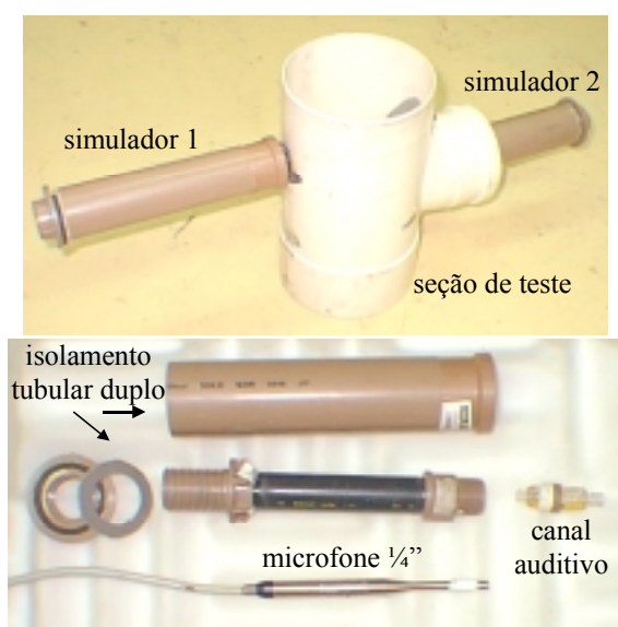
Figura 4.4 – Componentes da seção de avaliação dos protetores e dos canais auditivos simulados.
