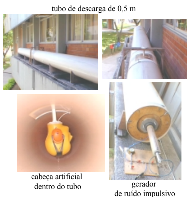
Figura 4.18 – Fotografias do tubo de descarga de 0,5 m de diâmetro, do gerador de ruído impulsivo e da cabeça artificial.
