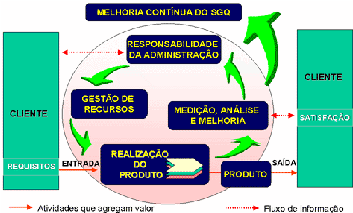
Figura 3 Modelo de um Sistema de Gestão da Qualidade Baseado no Processo (ABNT NBR ISO 9001:2000, 2000, p.2, fig.1)
