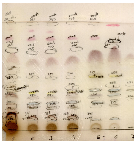
FIGURA 8: CCD de extratos de amostras comerciais de berinjela, eluída com diclorometano-metanol 95:5, revelada com vanilina-sulfúrica. As amostras são da esquerda para a direita: BP (1), ES1a (2), ES1b (3), ES2 (4), ES3 (5), ES4 (6) e EFC (7).
