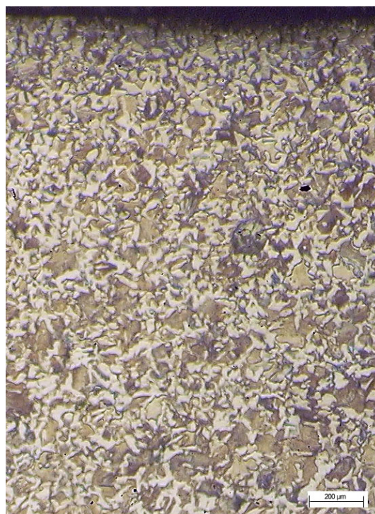
h) Amostra FeC 0,8% C – sinterizada forno plasma 30 min.
