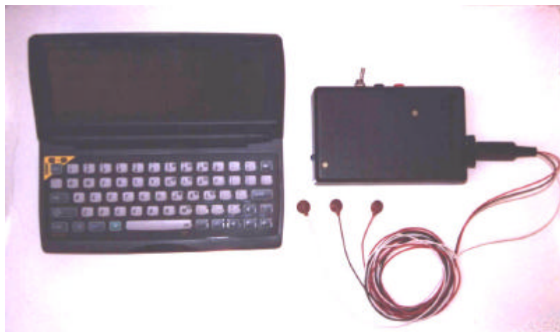
Figura 6.8 – Foto do sistema de aquisição completo. A distância entre o Palmtop PC e o módulo microcontrolado pode ser de até 1 m, estando a bateria em boas condições.
