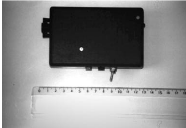
Figura 6.6 – Foto da caixa plástica onde foram alojadas a placa de circuito impresso e a bateria de 9 V. A caixa possui ainda uma chave L/D, dois conectores de acesso à bateria (para recarga, caso a bateria seja recarregável), um conector para o cabo de eletrodos e um orifício onde está alojado o LED infravermelho.
