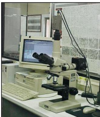
Figura 5.2: Microscópio e microcomputador utilizados para a análise microestrutural do CGI.
