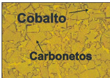
Figura 3.9: Microestrutura básica de um metal-duro (CIMM, 2002).
