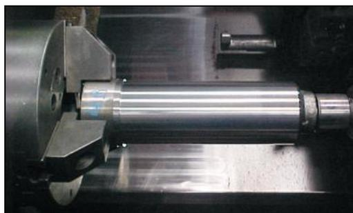
Figura 5.12: Sistema de fixação dos corpos de prova.
