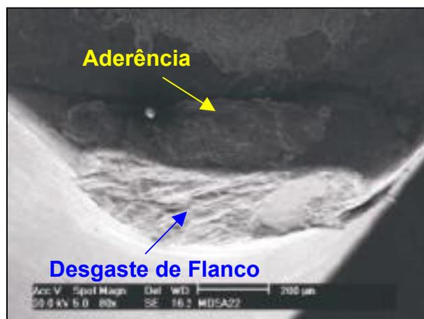
Figura 6.2: Caracterização do desgaste da ferramenta MD-A na condição 1.
