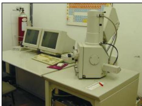
Figura 5.18: Microscópio eletrônico de varredura (MEV).
