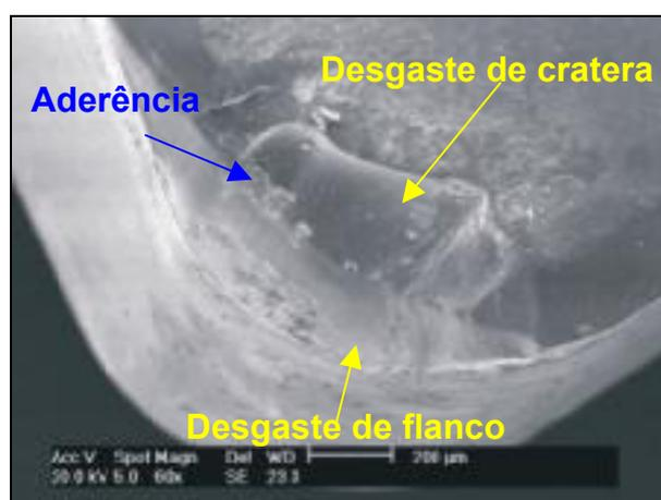
Figura 6.30: Caracterização do desgaste da ferramenta CR-B na condição 3.
