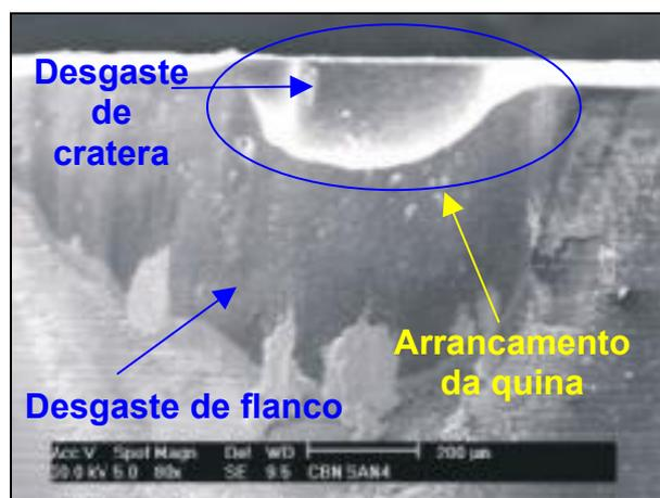
Figura 6.38: Caracterização do desgaste da ferramenta CB-A na condição 1.
