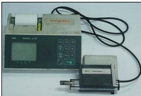
Figura 5.17: Rugosímetro utilizado para a aquisição dos valores de rugosidade  $R_z$ .
