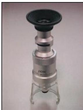
Figura 5.15: Lupa de ferramentaria para a medição do desgaste  $VB_{max}$ .
