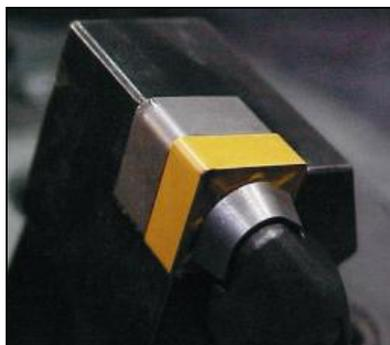
Figura 5.13: Ferramenta montada no suporte e fixada no torno.
