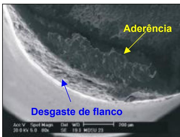
Figura 6.11: Caracterização do desgaste da ferramenta MD-B na velocidade de corte de 180 m/min.
