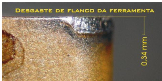
Figura 5.10: Critério de fim de vida: Marca de desgaste no flanco da ferramenta.
