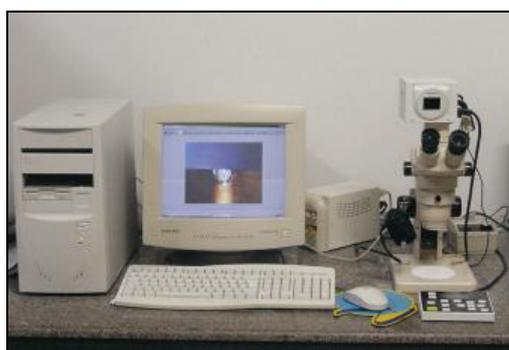
Figura 5.16: Sistema utilizado para a aquisição de imagens das ferramentas de corte utilizadas nos ensaios de torneamento.
