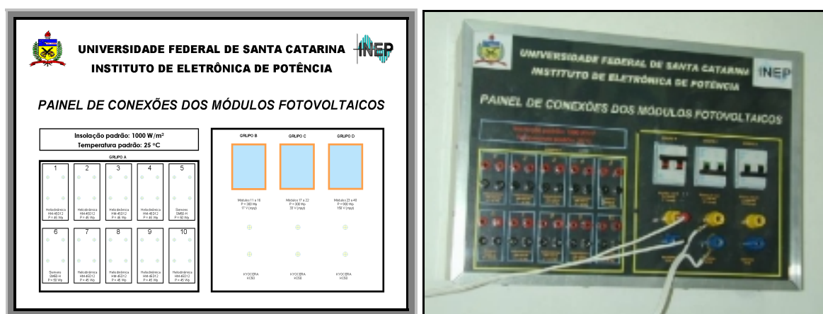
Fig. 4.4: Quadro para as conexões dos módulos fotovoltaicos instalados no Inep.
