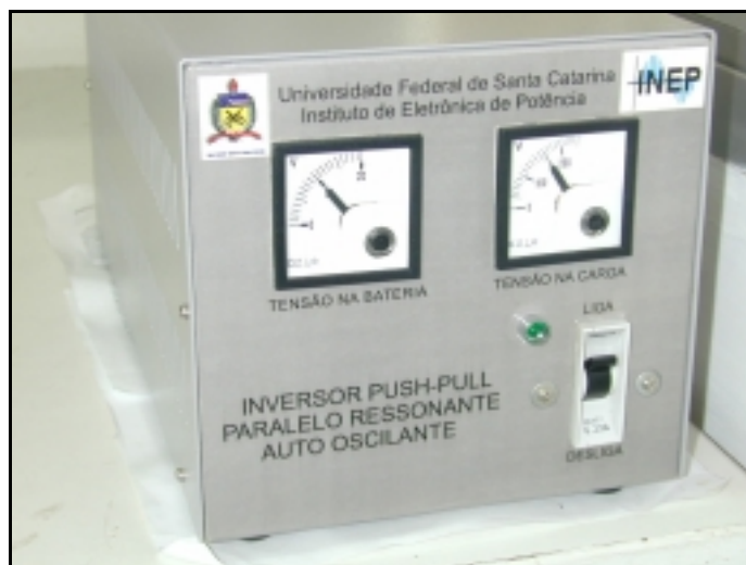
Fig. 4.7: Versão final do conversor para bombeamento de água desenvolvido no Inep.
