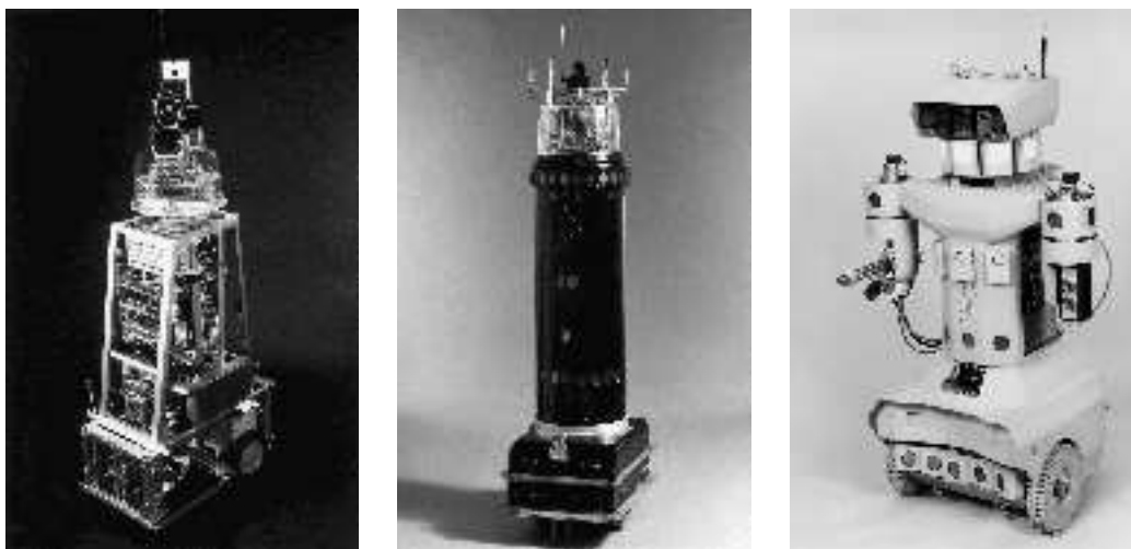
Figura 1.1: Robart I , Robart II e Robart III projetados pela marinha norte-americana para o patrulhamento indoor
