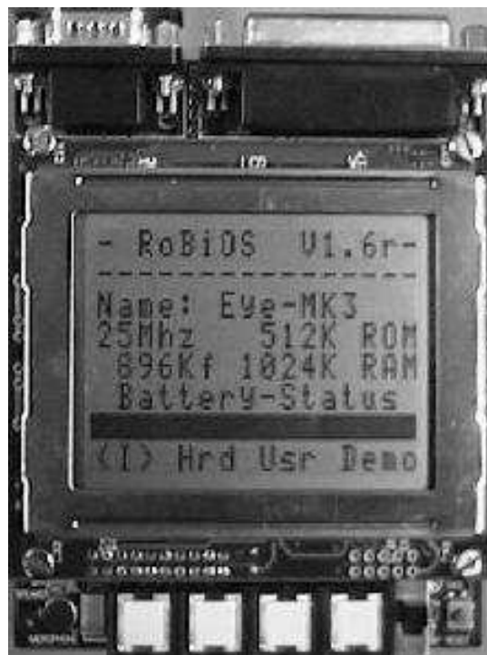
Figura 6.2: Imagem do LCD do controlador EyeBot
