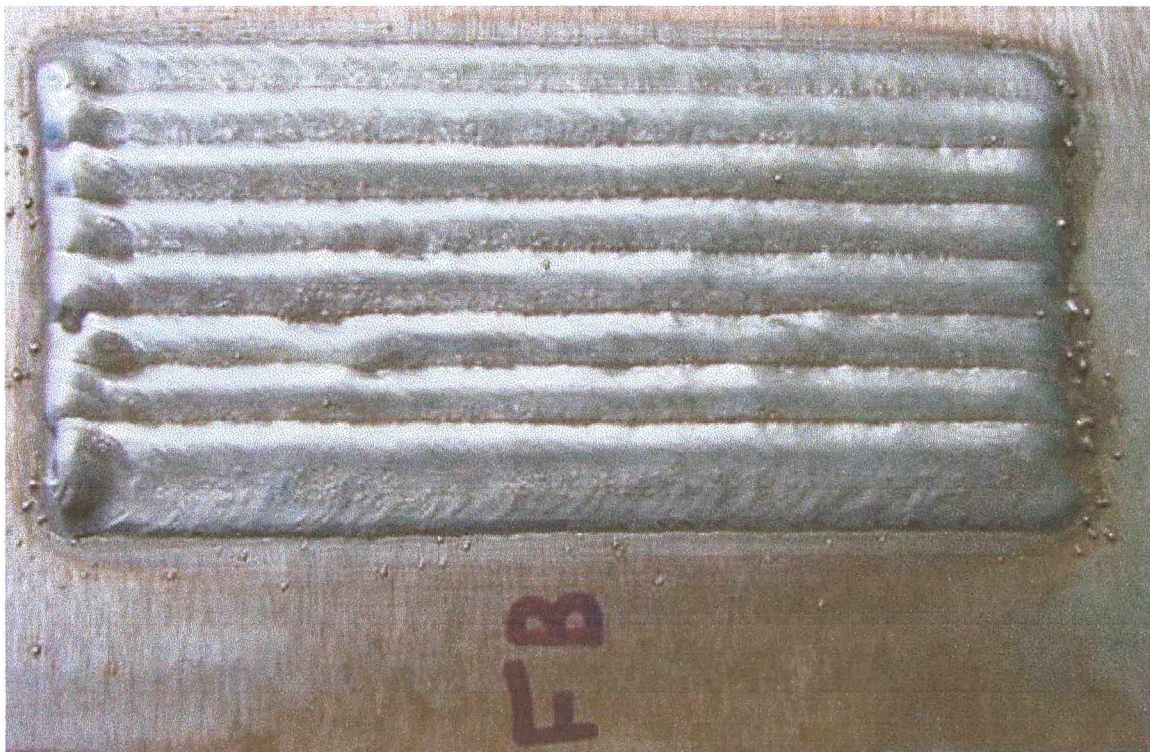
Figura 6.16 - a) e b) - Fotos das camadas depositadas na condição de pulsos de corrente em fase. Corrente média de 120 A/arame.
