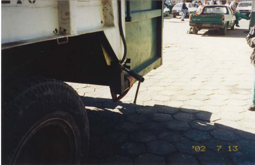
FIGURA 5 - MANGUEIRA UTILIZADA PARA A RETIRADA DO CHURUME (LÍQUIDO ACUMULADO DO LIXO)
