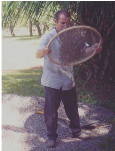
FIGURA 3.6 – Peneiramento da brita 1
