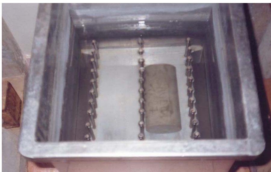
FIGURA 3.19 – Imersão dos corpos-de-prova 10x20 cm
