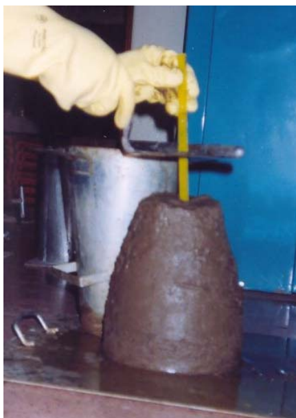
FIGURA 3.11 – Medida de abatimento do tronco de cone
