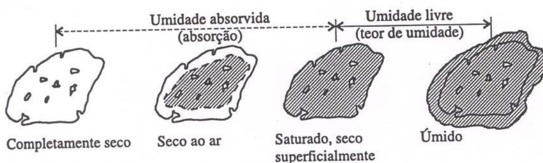
FIGURA 2.1 – Representação esquemática da umidade do agregado
