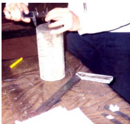
FIGURA 3.17 – Medida do diâmetro e colocação das barras
