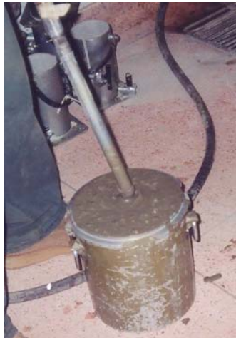
FIGURA 3.12 – Vibração do concreto no equipamento de ar incorporado
