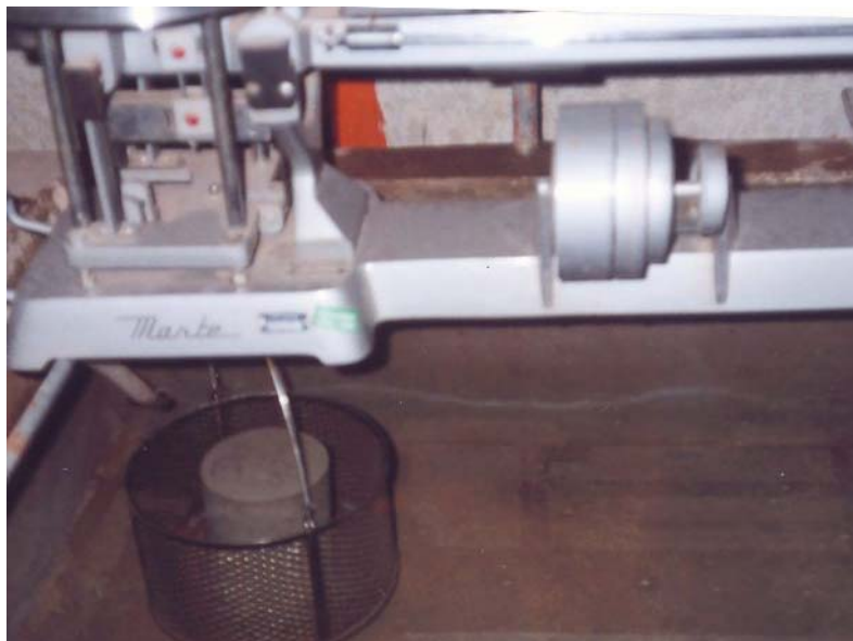
FIGURA 3.20 – Medida de corpos-de-prova submersos através da balança hidrostática
