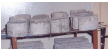
FIGURA 3.22 – Compartimento para garantir a ventilação em todas as direções
