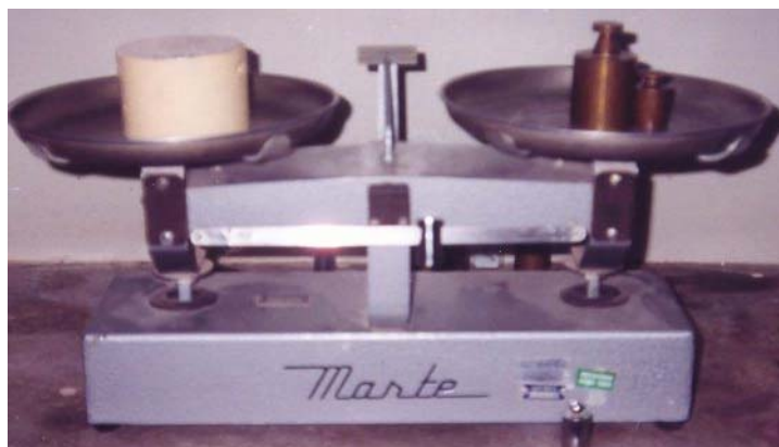
FIGURA 3.25 – Registro das massas após a aplicação da tinta esmalte
