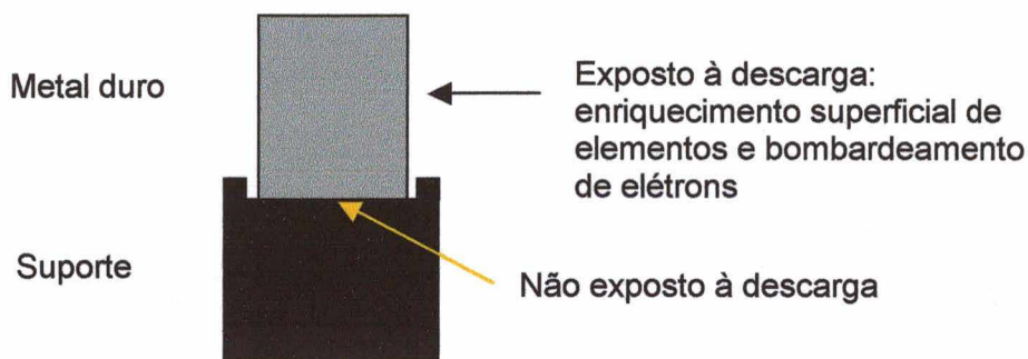
Figura 4.39. Disposição da amostra com respeito à descarga: regiões da amostra com e sem exposição à descarga.
