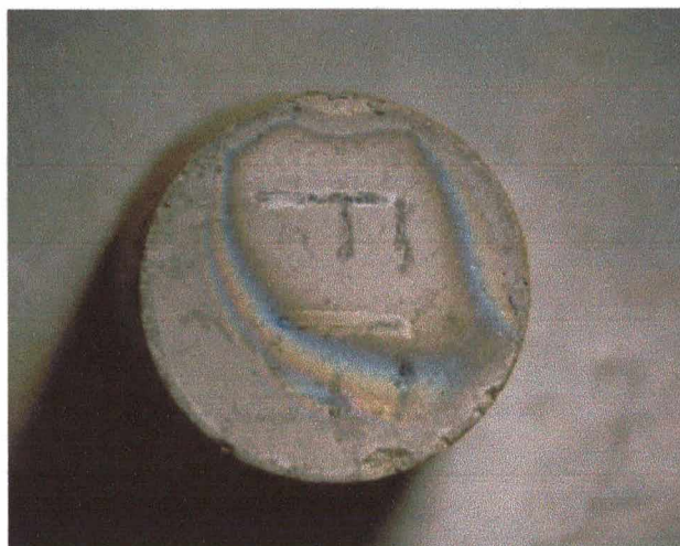
Figura 4.23. Fotografia de amostra durante a extração da parafina, detalhando as linhas de fluxo na saída da parafina líquida.
