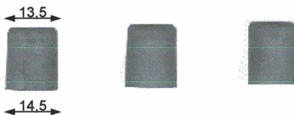
Figura 4.8. Amostras injetadas em forma de cone. Medidas em milímetros.
