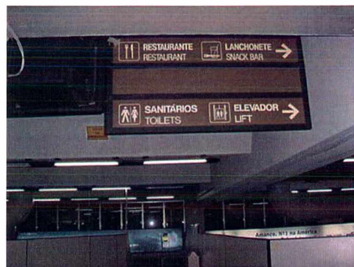
Figura 5.23 - Sinalizações inconsistentes: falta de contraste e pequenas.
