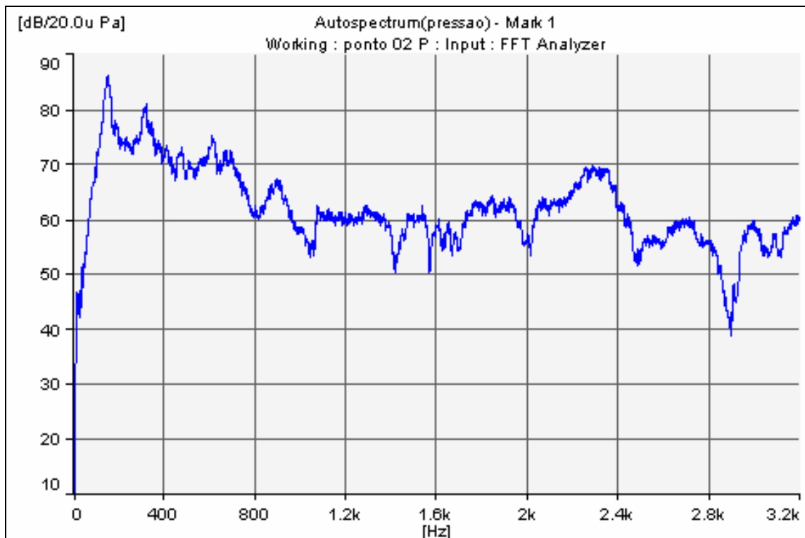
Figura 4.16 – Espectro de pressão do campo sonoro incidente no ponto 2 – placa lisa.
