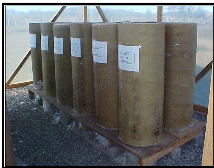
FIGURA 20 – VISTA GERAL DOS LEITOS DE SECAGEM EM BANCADA
