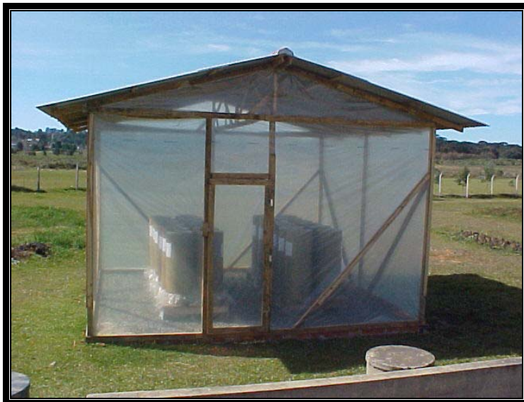
FIGURA 21 – ESTRUTURA EXTERNA DOS LEITOS EM BANCADA, DE MADEIRA COM VEDAÇÃO DE PLÁSTICO DE ESTUFA E ETERNIT
