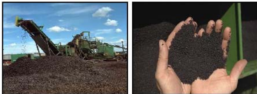
FIGURAS 5.3 e 5.4: Borracha de pneu moída resultante da trituração mecânica.
