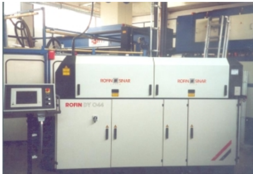
Figura 5.1 - Fonte de laser Nd:YAG modelo Rofin Sinar DY044.
