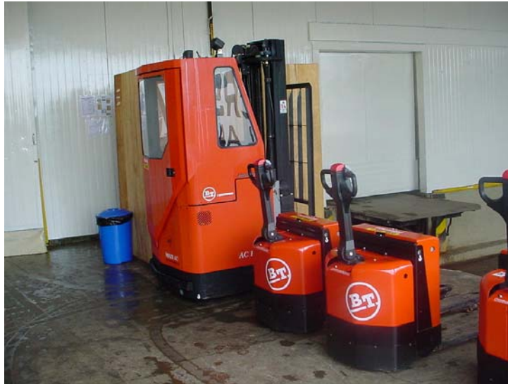
Figura 5.1 – Empilhadeira climatizada e paleteiras elétricas
