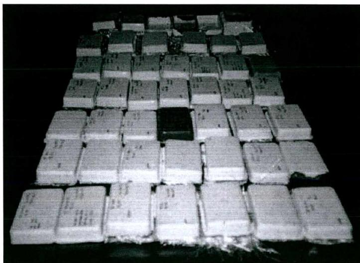
**FIGURA 35** - Peças de PRFV produzidas pelo processo de laminação manual.
