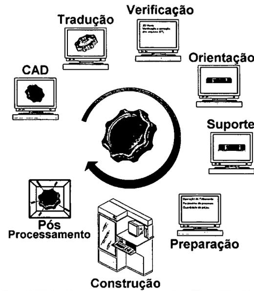
FIGURA 15 - Etapas do processo de estereolitografia.
