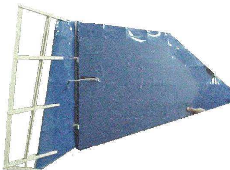
Figura A1.6: Superfície aerodinâmica do AS800-1 (coberta) e sua extensão para uso no AS800-2.
