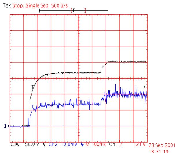
Fig. 6.24 – Tensão de saída e corrente de entrada durante o transitório de partida para  $V_{in}=31V$ . Escalas: 50V/div, 2A/div.
