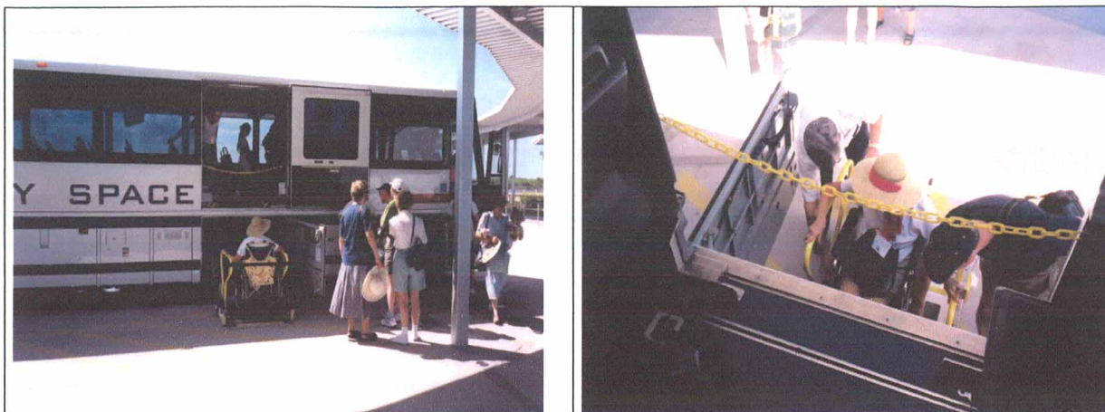
Figuras 133 e 134 : Elevador para acessar ônibus
