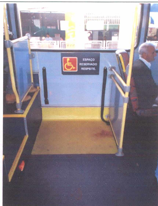
Figura 130: Ônibus adaptado, área interna para o cadeirante.
