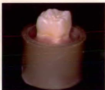
Figura 3a-Inclusão da porção radicular do dente em uma base com resina acrílica
