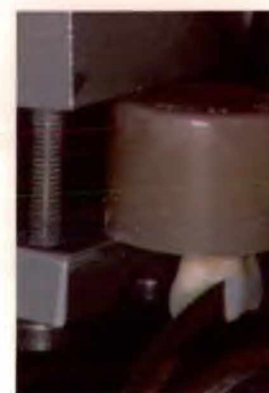
Figura 3c-Base fixa na cortadeira para corte dos blocos de esmalte
