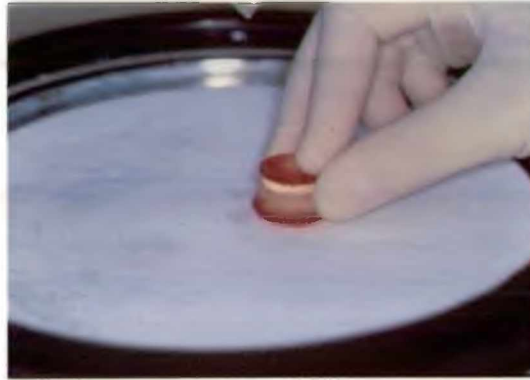
Figura 8 – Polimento das superfícies dos blocos de esmalte com discos de feltro e pastas de diamante
