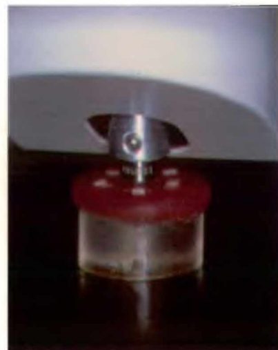
Figura 9b -Indentação sendo realizada através de um indentedor tipo Knoop
