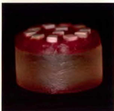
Figura 6a -Base de resina epóxica com uma camada uniforme de cera utilidade
