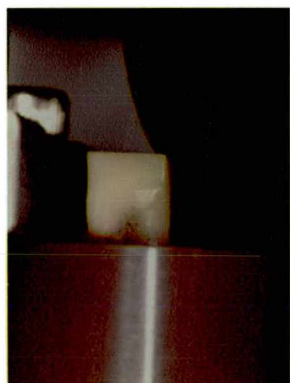
Figura 9 – Conjunto dente/tubo PVC posicionado na politriz durante o seccionamento com disco de dupla face.
