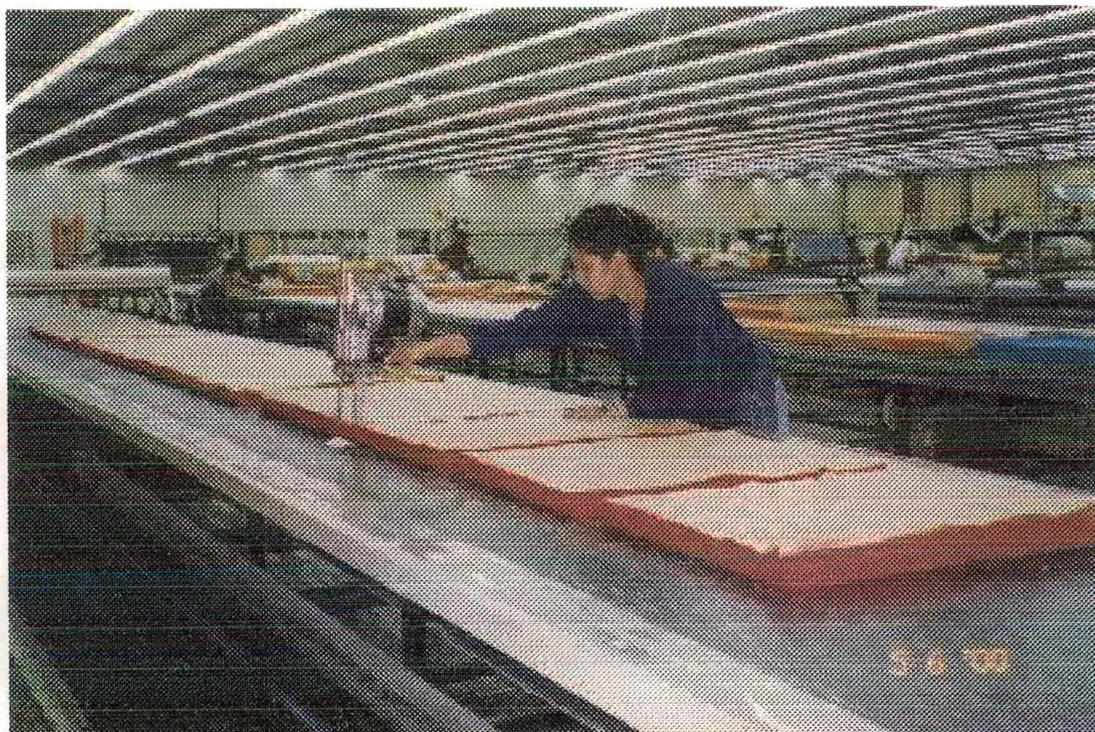
Na Foto 17 temos a máquina de corte com controle computadorizado, que funciona com um sistema em CAD/CAM.
