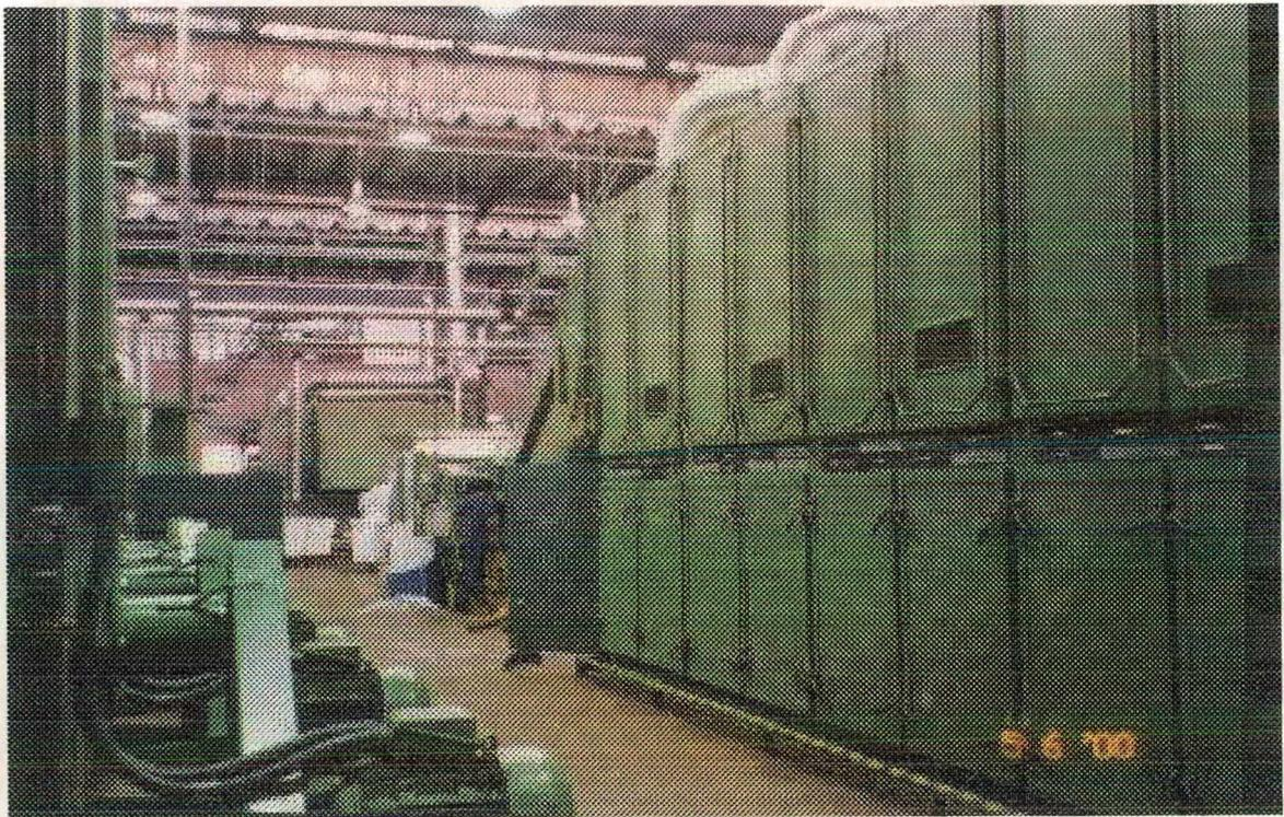
Após a secagem, a malha passa pela "calandra compactadeira", se for do tipo normal (Foto 12), ou para a "rama", no caso de ser a malha *body-size*, fotos 13 e 14.
