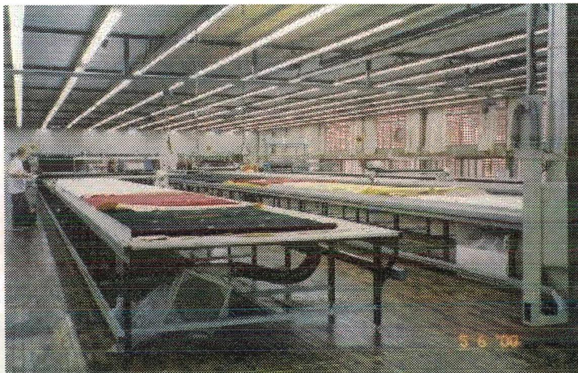
Na Foto 16 temos o processo manual de corte do tecido, que é feito com uma serra; o tecido é cortado com uma serra sobre moldes de papelão.
