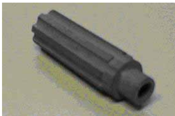
Figura A2. 2Foto do elemento poroso cilíndrico ranhurado.
