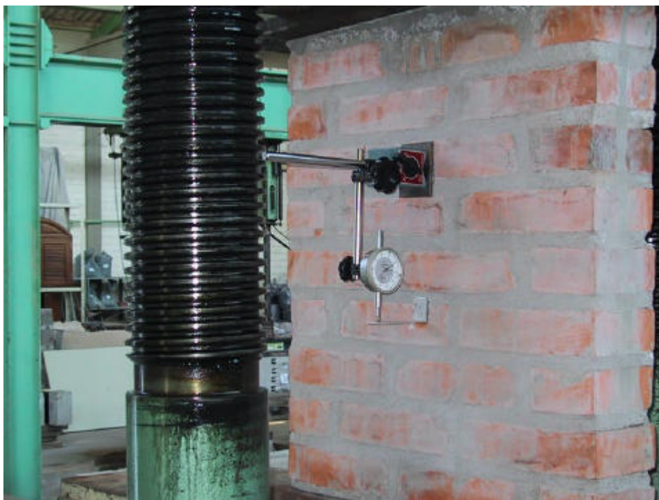
Figura 18 : Medição das Deformações Verticais das Mini-paredes
