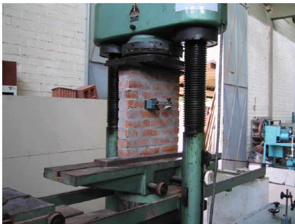
Figura 19 : Medição das Deformações Horizontais das Mini-paredes
