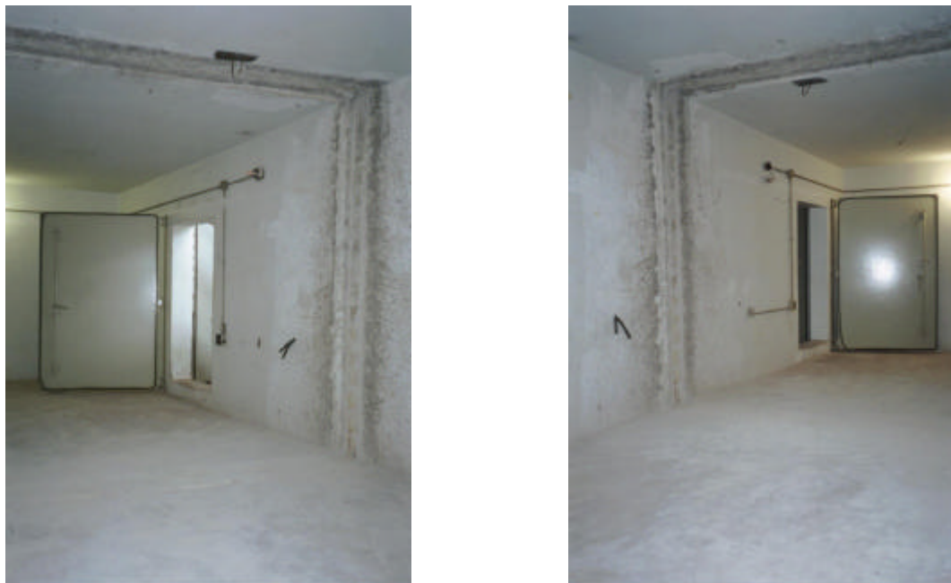
Figura 7 : Fotos das câmaras da UFSM para ensaios de transmissão sonora.
