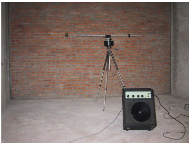
Figura 11 : Fonte geradora e microfone rotativo nos ensaios de Índice de Redução Sonora.
