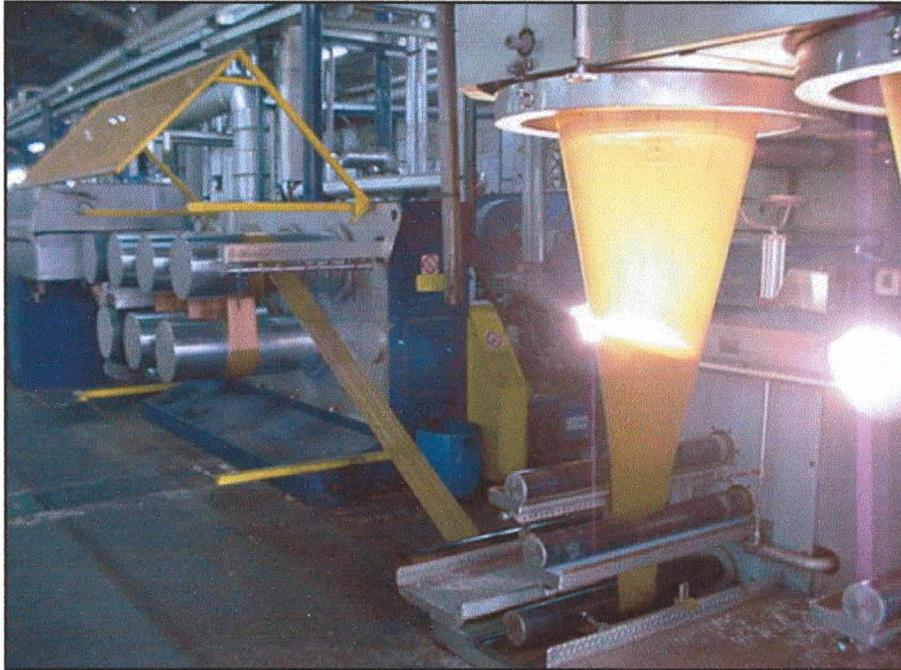
Figura 2.1– Processo de extrusão estirada das fibras de polipropileno.
