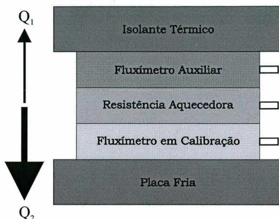
Figura 3.11 – Montagem para calibração do fluxímetro de calor. Extraída de Güths (1994).
