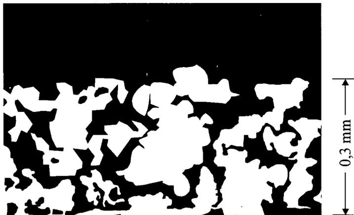
Figura 2.7 – Seção transversal da superfície High Flux. Extraída de Webb (1994).
