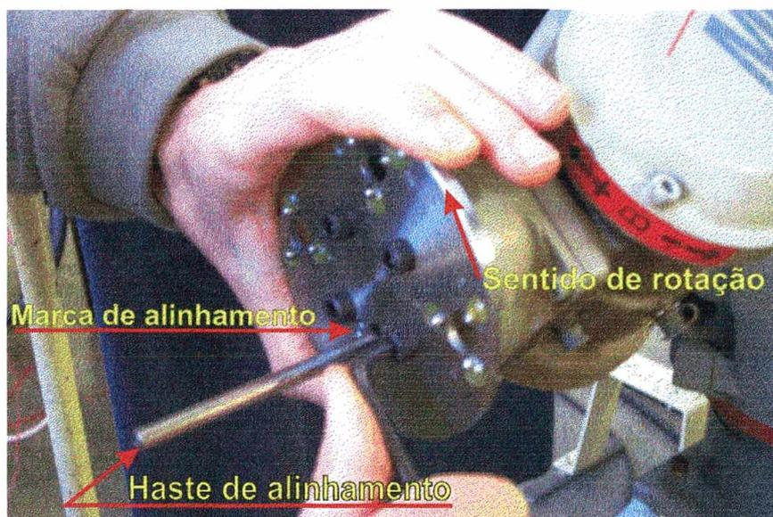
Figura 4.12 Montagem do flange de medição.
