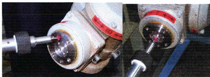
Figura 4.11 Medição do círculo projetado no plano para alinhamento.
