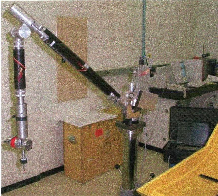
Figura 3.6 Braço de medição disponível no Labmetro.
