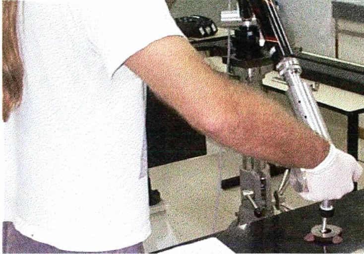
Figura 5.15 Medição de anel padrão com o braço de medição.
