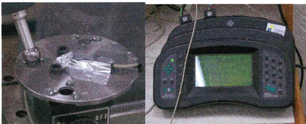
Figura 5.9 Flange com transdutor de temperatura e indicador.
