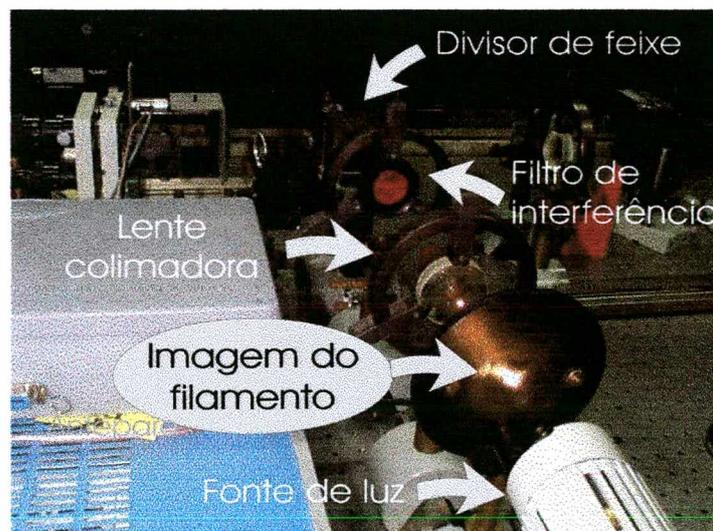
Figura 3.3 Projeção do filamento da lâmpada de halogênio
