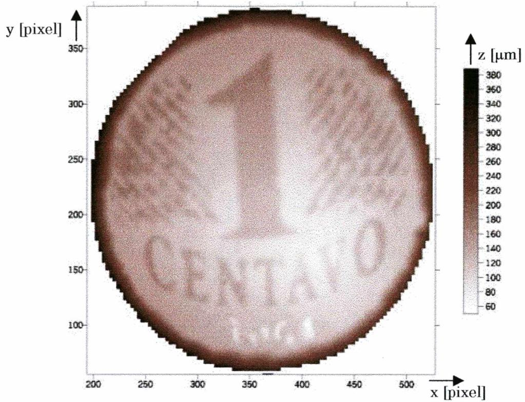
Figura 3.16 Representação por cores da moeda de 1 centavo. A escala de cor está associada à altura do objeto
