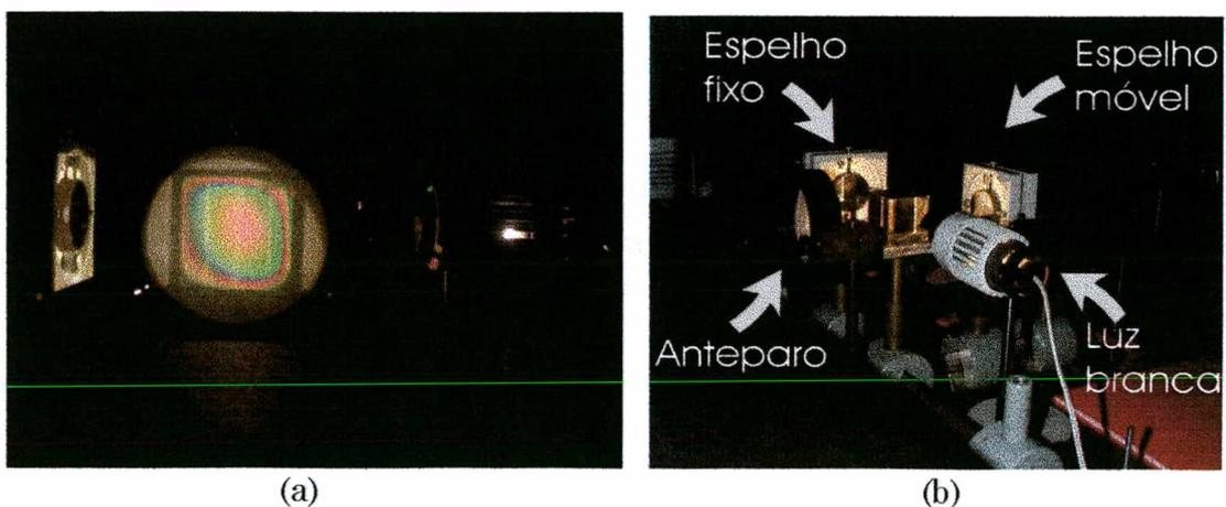
Figura 2.4 (a) Padrão de interferência com luz não-coerente e (b) montagem experimental
