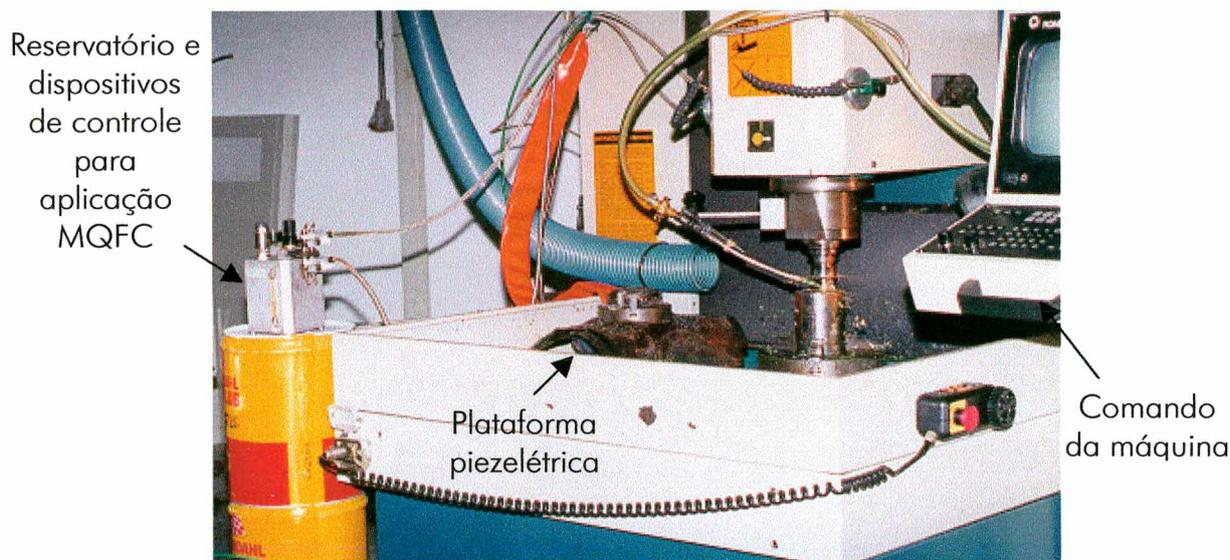
Figura 28 - Bancada experimental para execução dos experimentos.
