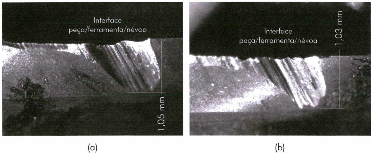
Figura 46 - Marcas de desgaste máximo final no flanco principal após 171 cm<sup>3</sup> de material removido por gume: a - Fresa C2; b - Fresa C3.
