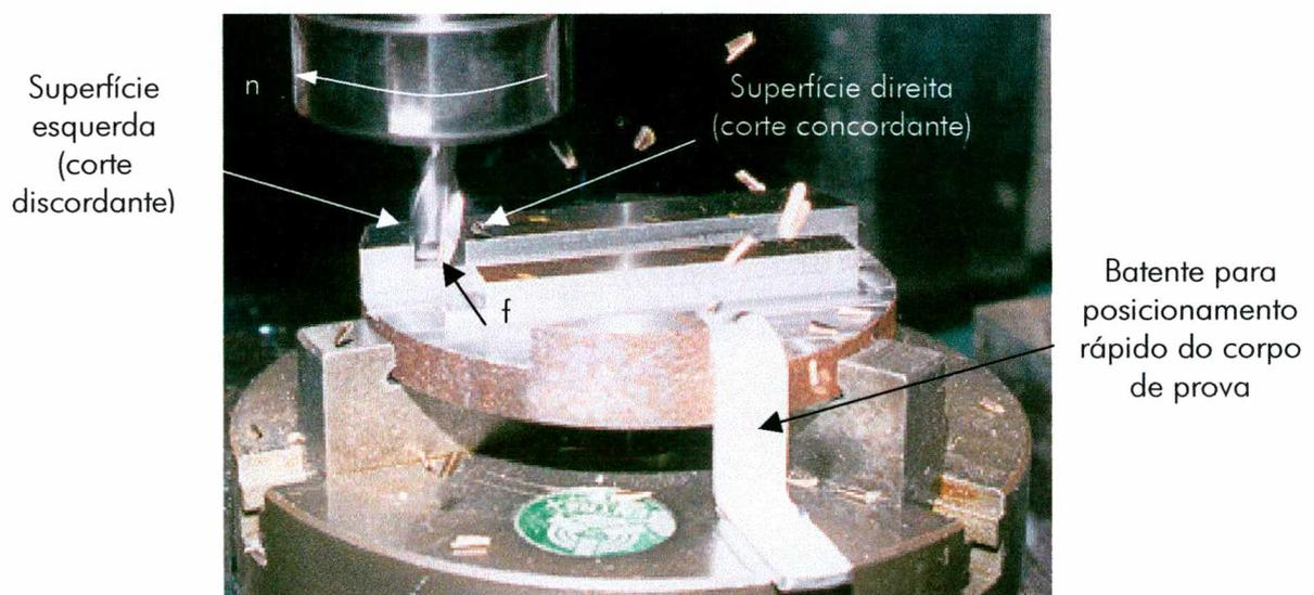
Figura 27 - Fresa usinando o canal para aquisição dos dados de rugosidade.
