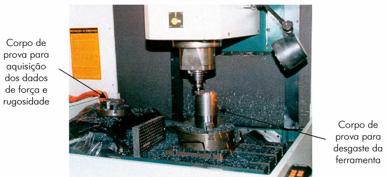
Figura 23 - Disposição dos corpos de prova na mesa da máquina-ferramenta.
