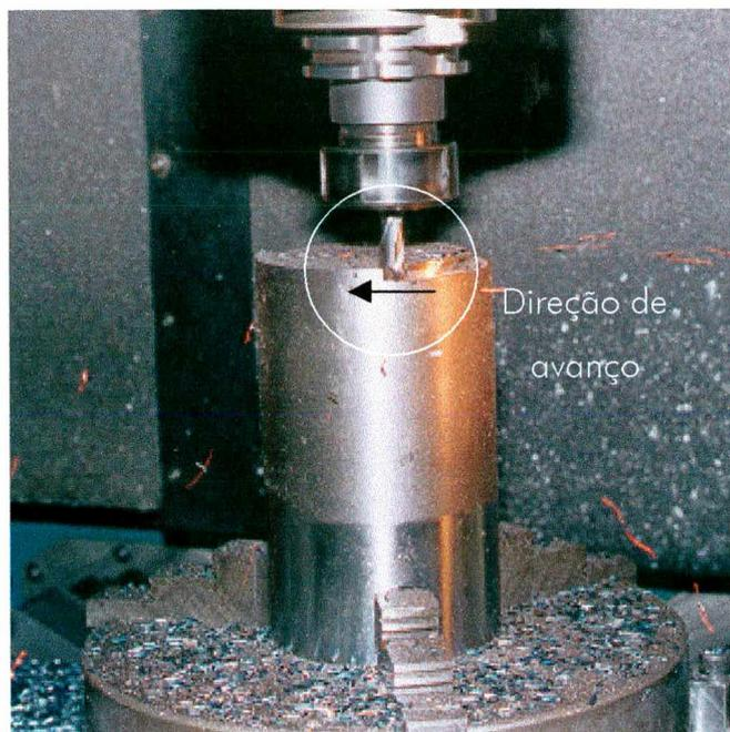
Figura 25 - Processo de usinagem com a ferramenta de metal-duro (usinagem a seco).
